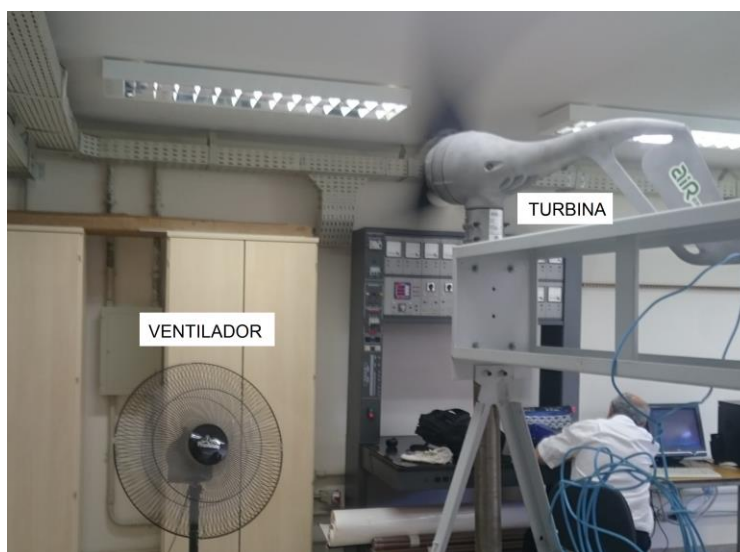
Figura 4: Acionamento da turbina empregando um ventilador de coluna. Do autor
